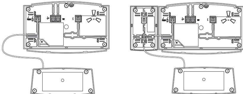
1. Retirer le câble de raccordement du téléphone de la prise située sous le téléphone.
