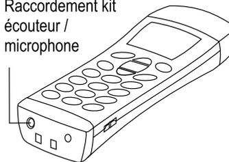
Il est possible de raccorder les kits écouteurs avec jacks de 2,5 mm que l'on trouve couramment dans le commerce à la partie inférieure du combiné.
